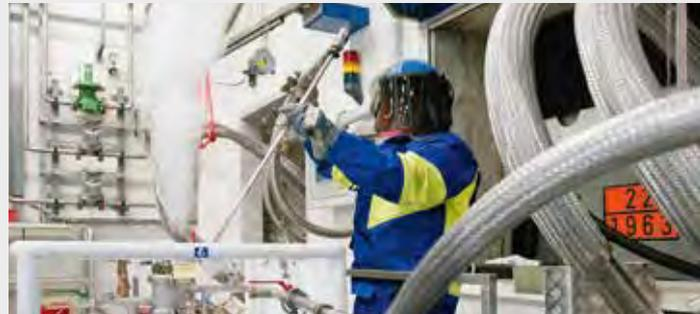
Umfüllen von flüssigem Helium (-269°C) im Spezialgasfüllwerk.
