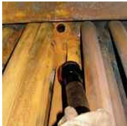
*Ispezione visiva di uno scambiatore di calore.*
