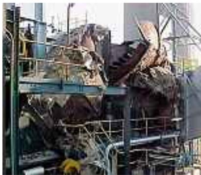
*Esplosione di un'attrezzatura a pressione (caldaia) in una raffineria.*
