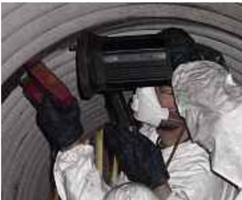
*Magnetoscopia di un giunto circolare interno di un tubo ondulato in una caldaia a doppio tubo di fumo.*
