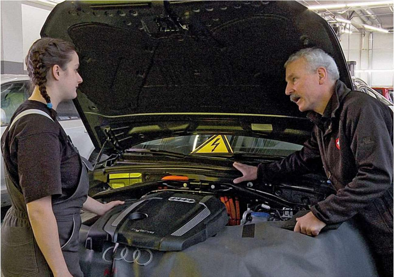
Abbildung 3: Hybridfahrzeuge stehen unter Hochspannung und dürfen erst gewartet werden, wenn sie spannungsfrei geschaltet wurden.
