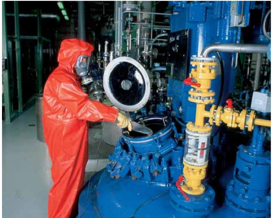
*Riempimento di un reattore con polveri: questa illustrazione non costituisce una soluzione ideale. Le soluzioni da privilegiare sono di tipo tecnico, come ad esempio il trasferimento pneumatico sotto vuoto a circuito chiuso che permette di evitare l'esposizione del lavoratore senza ricorrere a dispositivi di protezione individuale.*
