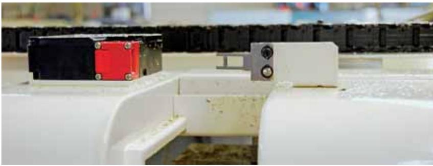
La macchina parte solo quando il contropeso fissato sul dispositivo di protezione si inserisce nell'interruttore di controllo.
