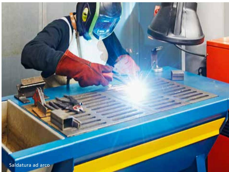
Saldatura ad arco
