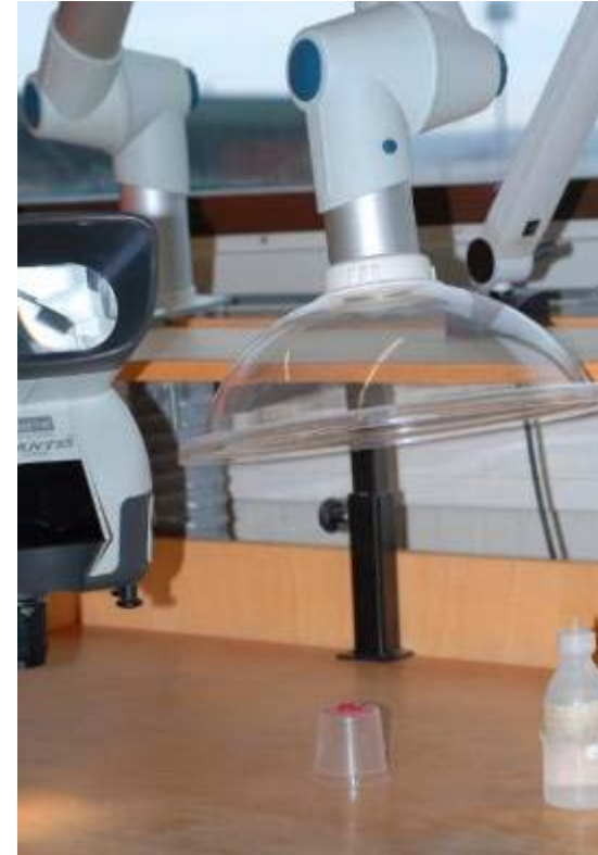
Montagearbeitsplatz mit Absaugung
