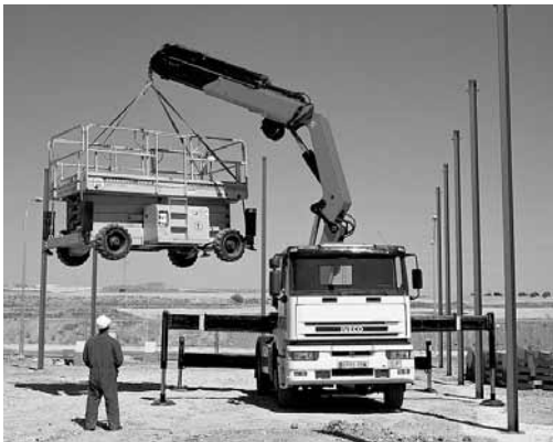
Bild 6 Fahrzeugkran: Lastwagenladekran mit einem Lastmoment von mehr als 400'000 Nm oder einer Ausladung von mehr als 22 m
