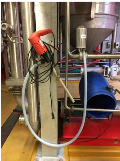
Die Lauge wird künftig mit einer Fasspumpe direkt bei der Rätzmühle in den Reinigungskreislauf gegeben.
